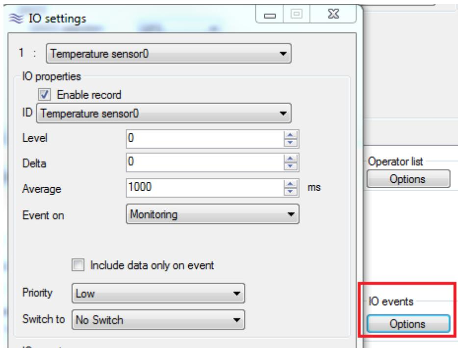
Перейдите в Параметры IO событий конфигуратора и настройте каждый параметр, как показано на рисунке выше. Датчик температуры 0 – это фактически датчик 1. При подключении более одного датчика температуры, включите остальные параметры ввода-вывода:
